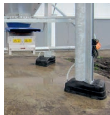
Ostony nóg silosu dla bezpiecznego ważenia w ekstremalnych warunkach pogodowych
