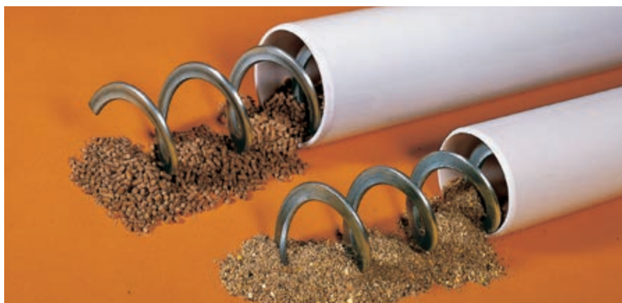
Przenośnik spiralny typu FlexVey – prosty i elastyczny system transportu paszy
