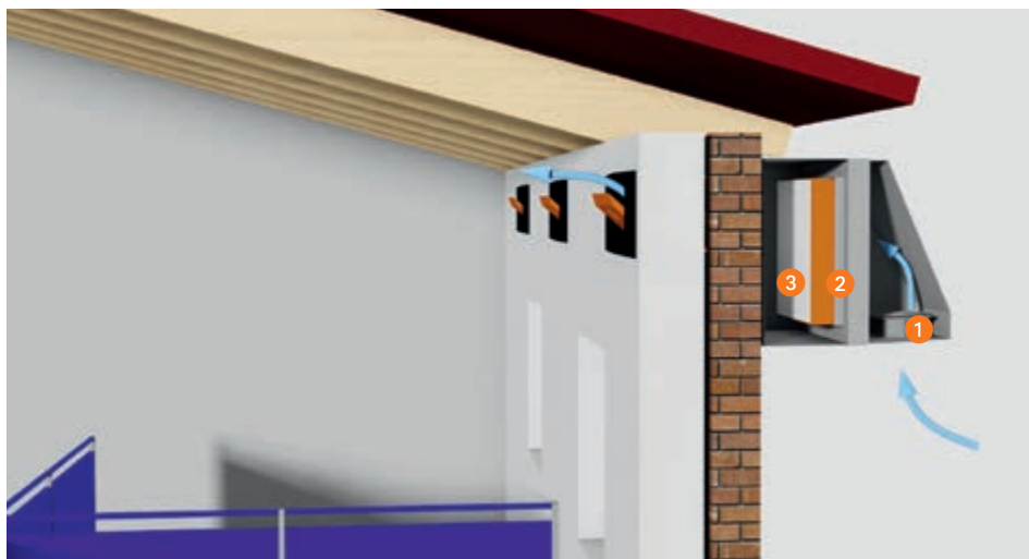
Schemat działania APT 1500 przy decentralnym systemie doprowadzenia świeżego powietrza przez wlot ścienny CL 1200
